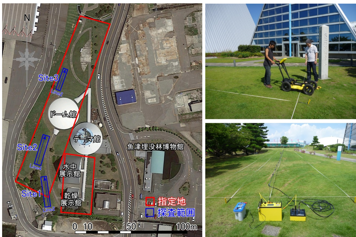
図 6-50 探査範囲と実施状況 (上 : GPR 探査, 下 : 高密度電気探査)
