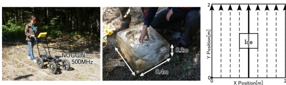
図4-1 探査風景と測線の設定状況
