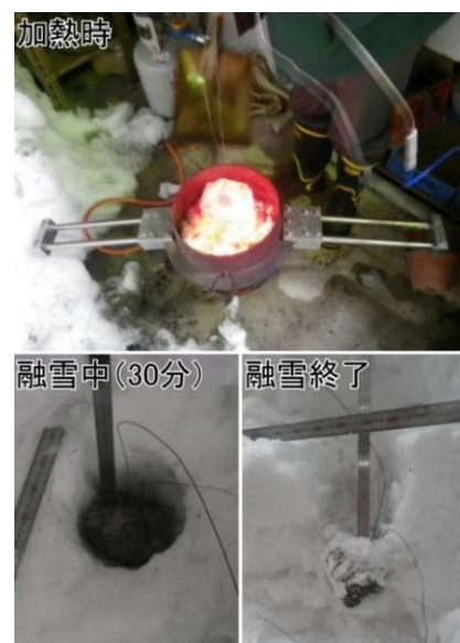
図 4-31 融雪実験の実施状況
