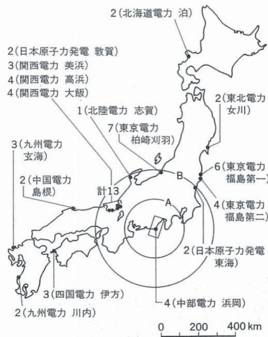
図1 日本の原子力発電所の分布。数字は運転中の原子炉の数。浜岡原発を囲む矩形は東海地震の予想震源断層面の地表投影 (2) 。円は、浜岡3号炉が炉心溶融をおこしたときの風下側の長期避難領域を示す (10) 。(Aはチェルノブイリ事故の際に旧ソ連が設定した基準、Bは白ロシア共和国が設定した基準による)。
