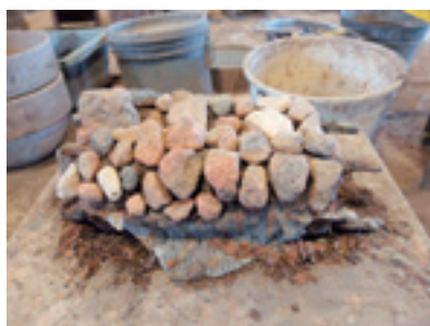
27 粘土汁で鑄型の破片をつけて、土の水分を吸着させていく。
