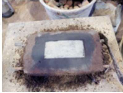
15 角のバリを切り落とす。また蜜蝋の板の周囲をヘラで水をつけてならしながら整える。
