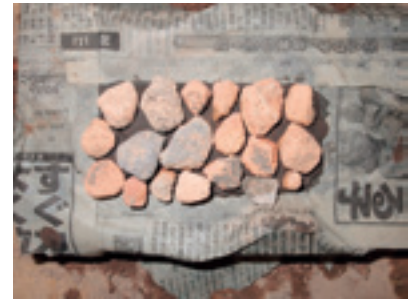
20 鑄型の破片を置き、土の水分を吸着させる。
