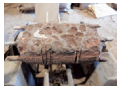
28 乾いたら、四隅をヘラで切り取り整える。水で側面をならして、ヘラで線をつける。
