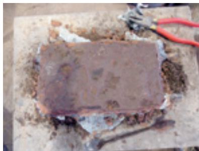
25 鑄型の破片を外して、周囲をヘラで整え、鉄線をおく。
