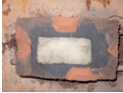
16 湯口を2カ所につくる。また、合わせ型のかみ合わせ部分を造る。
