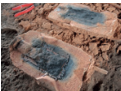
39 冷めたら型を割る。針金を外す。
