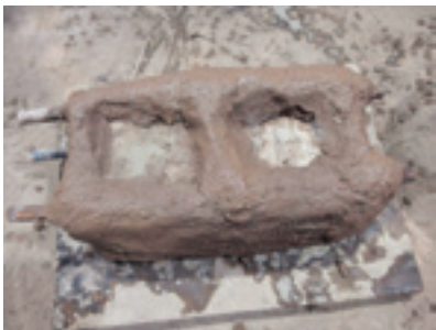
34 鉄線が隠れるように、粘土汁を塗りながら、最後に土 ※3 で全面を覆う。
