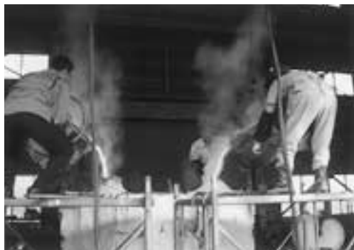
6. 自硬性鑄型に銅87%、錫12.5%、亜鉛0.5%の青銅を注湯する
