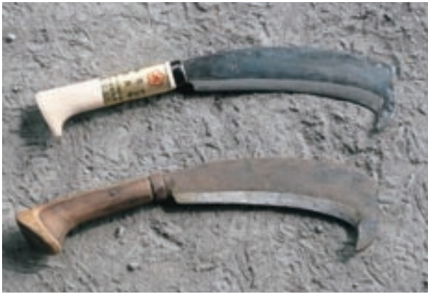
図5 メンテナンスされている刃先のライン 上：大久保氏の泊鉈（新品）。下：使用者長崎順一氏所有の泊鉈（柄は付け替えている）は、僅かではあるが良く使用される部分のライン曲率が大きい。
