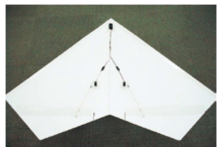
写真15 補助翼のサイズを変更
