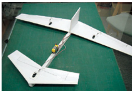
写真21 水平先尾翼にもサーボを搭載
