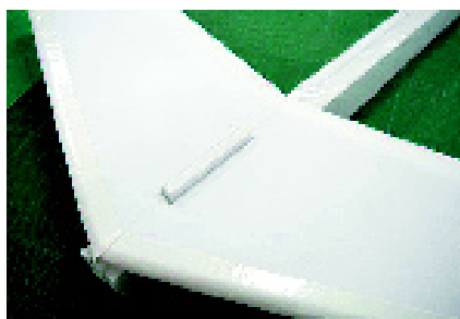
写真18 エッジを削り空気抵抗を抑える
