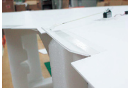
写真7 上下に補助翼が可動
