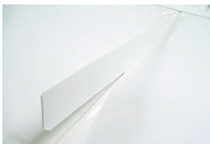
写真25 胴体に芯材を入れ強度を上げる
