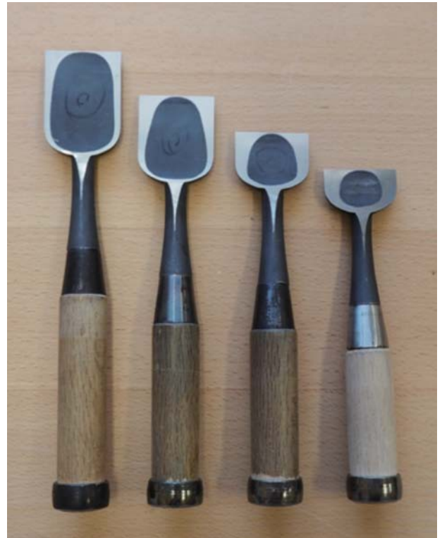
写真7 短くなっていくノミの刃と、残り続ける裏透きの様子
