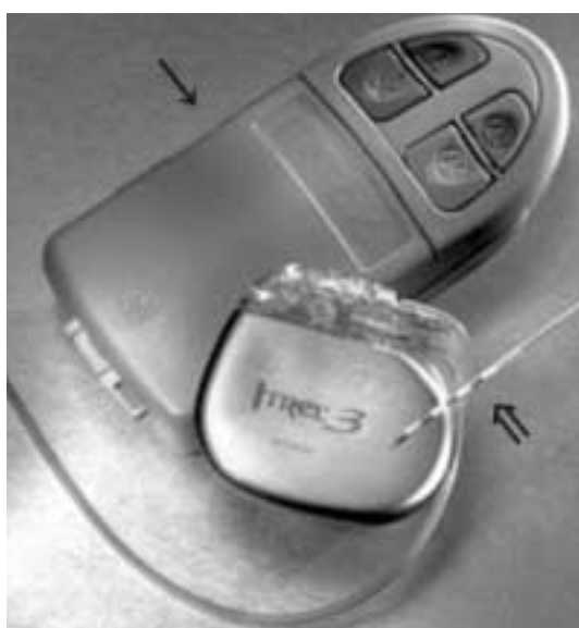
図2 刺激装置 (Medtronic社) Itrel3 IPG (Model 7425) (中央), アイトレルEZプログラマー (Model 7434A) (→), リード電極 (Model 338728) (⇒)
