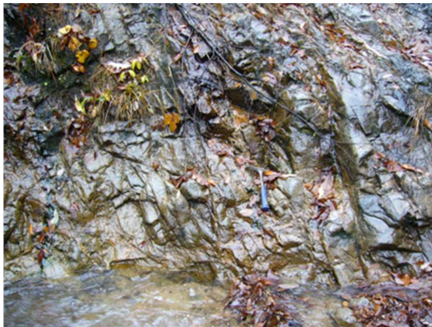
写真 2 トンネル起点側 花崗岩露頭状況 (CM～CH 級)
