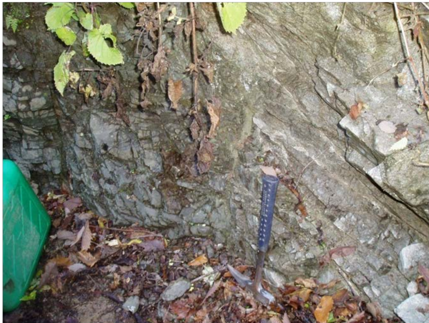
写真8 トンネル終点側坑口部周辺の岩盤状況 安山岩と花崗閃緑岩の境界部，節理間隔は 5～10cm 程度，全体に破砕され脆弱な印象を受け CL 級．
