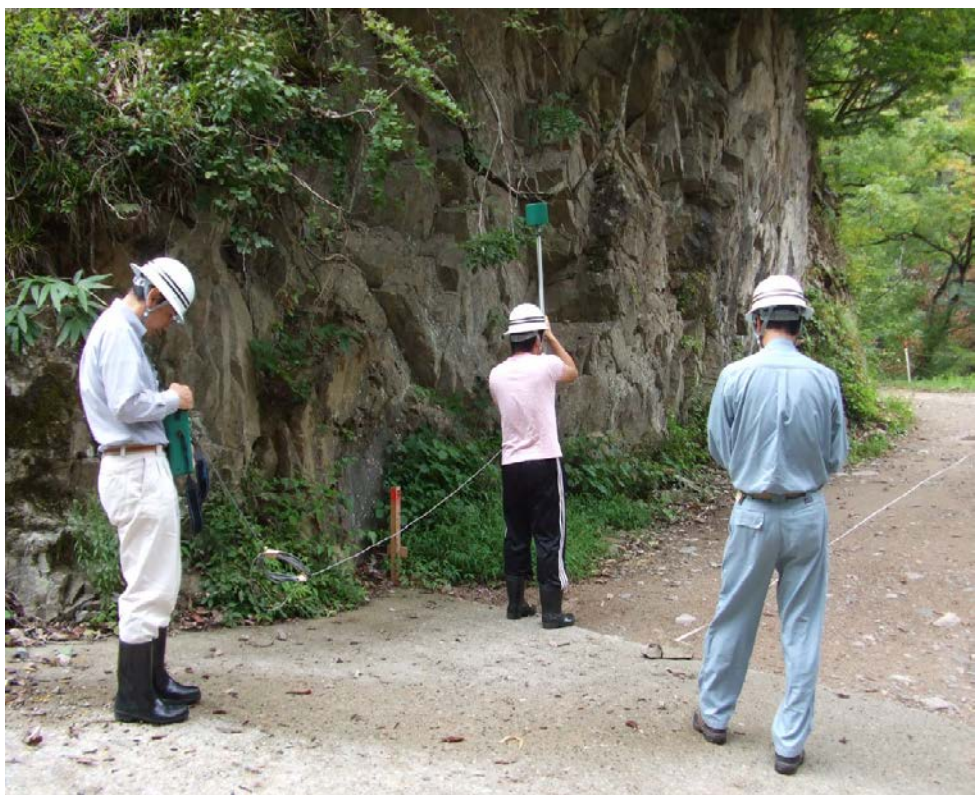
写真 2.1 プロトン磁力計による地上磁気測定状況
