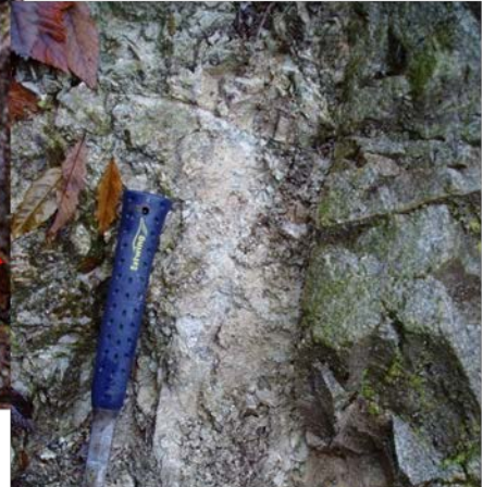
写真 5 滝左側部分の近接 変質の進む花崗閃緑岩中には、幅 30～50cm の青灰色粘土が所々に挟在している。
